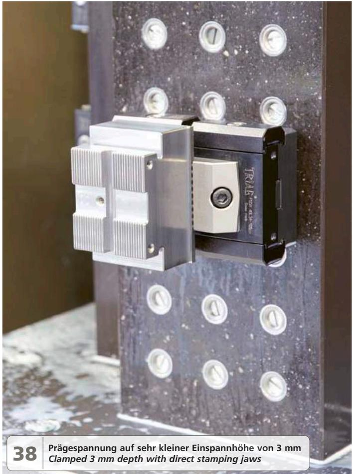
**38** Prägespannung auf sehr kleiner Einspannhöhe von 3 mm
