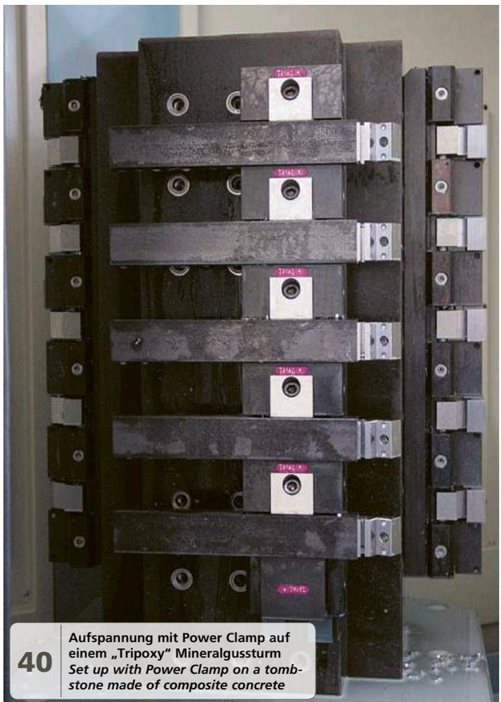
**40** Aufspannung mit Power Clamp auf einem „Tripoxy“ Mineralgussturm
