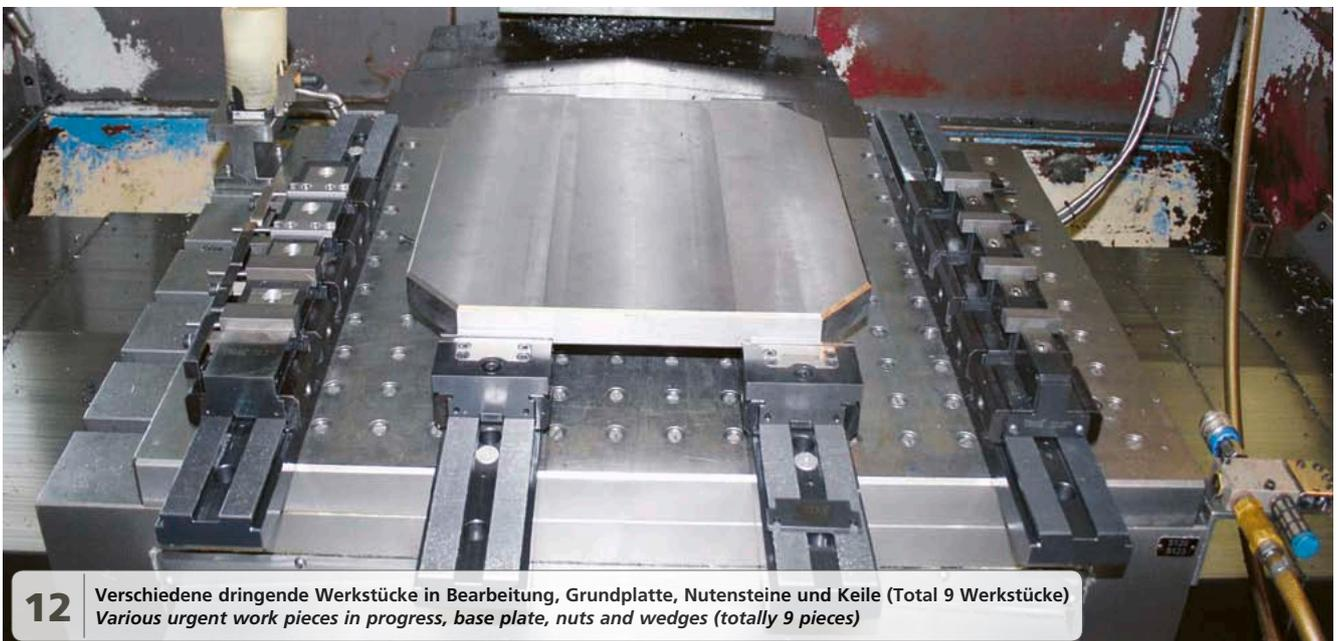
12 Verschiedene dringende Werkstücke in Bearbeitung, Grundplatte, Nutensteine und Keile (Total 9 Werkstücke)
